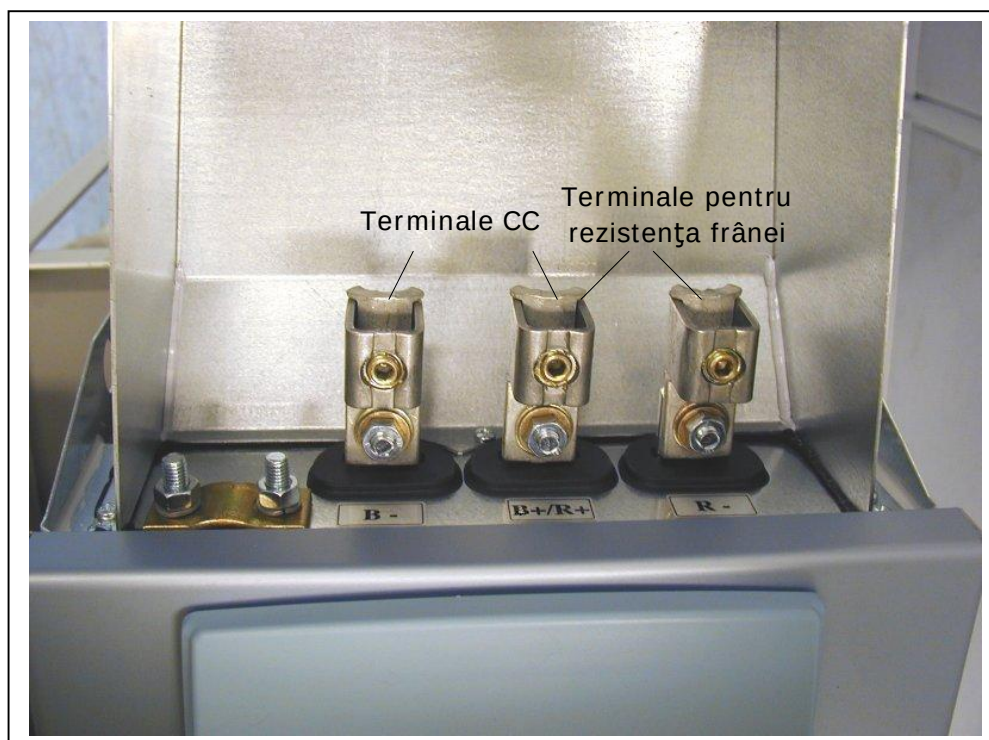
Figura 6-18. Cutie pentru terminalele rezistenței frânei, în partea superioară a modelului FR8
