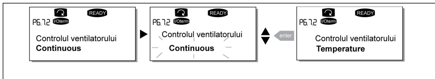
Figura 7-22. Funcția de control al ventilatorului
